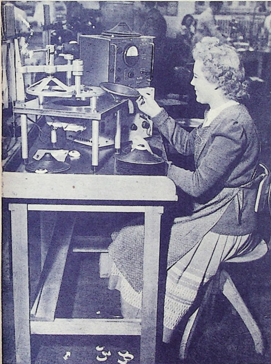
Lautsprecher-Membranen für Rundfunkempfänger werden am Prüfplatz vor dem Zusammenbau auf ihre Eigenfrequenz untersucht, damit auch in der Großserienfabrikation die klanglichen Eigenschaften genau eingehalten werden können. Ein aus einem Tongenerator gespeister Lautsprecher bildet die zu untersuchende Membran mit veränderlicher Frequenz an. Die Eigenresonanz des Prüflings ist an der größten Schwingweite erkenntlich; sie wird am Tongenerator abgelesen und auf der Membran verzeichnet. (Aufnahme aus der Telefunken-Fertigung: C. Stumpf)
